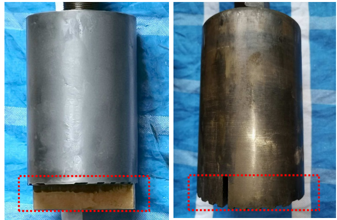
左右两个柱塞的卡槽对齐安装
